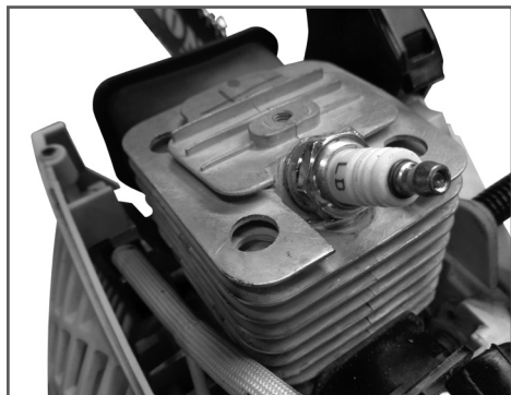
Рис. 28 Охлаждающие ребра цилиндра
