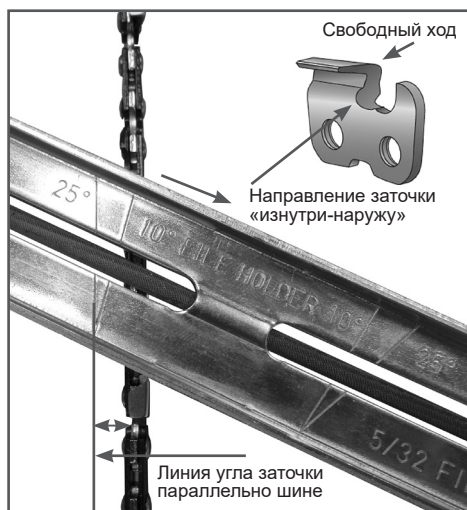
Рис. 22 Расположение линии угла заточки
