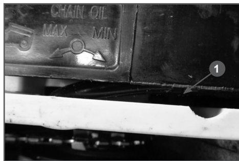
Рис. 8 Винт регулировки подачи масла
