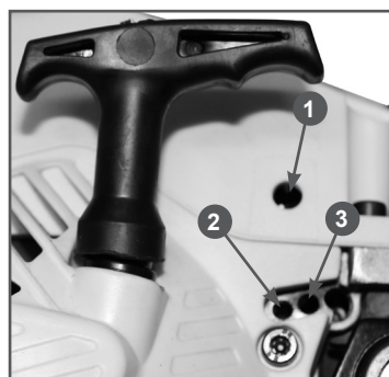
Рис. 20 Винты регулировки карбюратора
