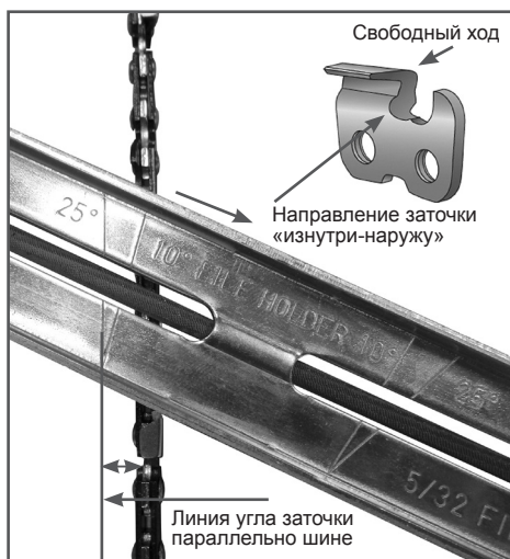
Рис. 22 Расположение линии угла заточки
