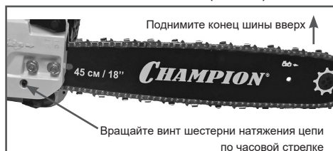
Рис. 5 Регулировка натяжения цепи
