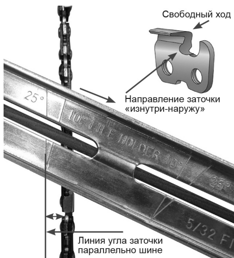
Рис. 15. Определение угла заточки
