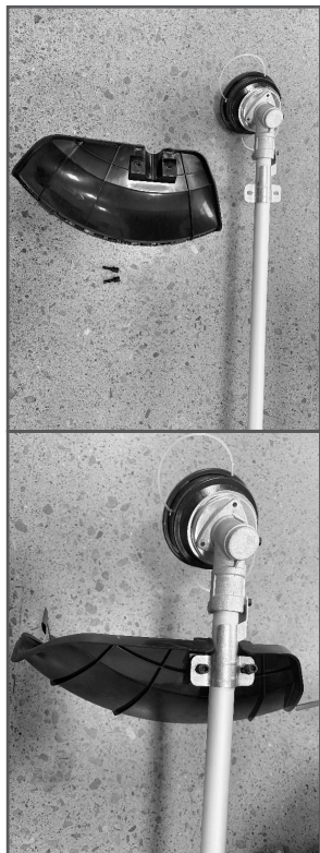
Рис. 3 Установка защитного кожуха
