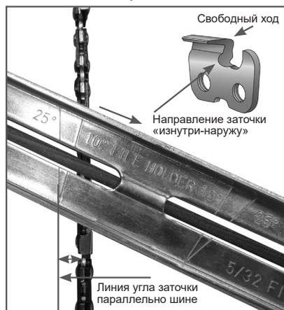
Рис. 34. Определение угла заточки
