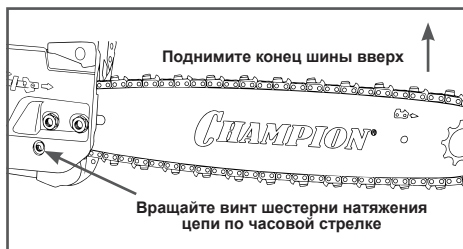
Рис. 6. Регулировка натяжения цепи
