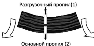
Рис. 24. Распиливание дерева, когда его нижняя часть находится под напряжением
