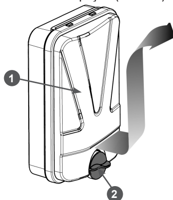
Рис. 15. Снятие крышки воздушного фильтра
