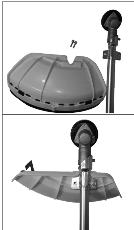
Рис. 3 Установка защитного кожуха
