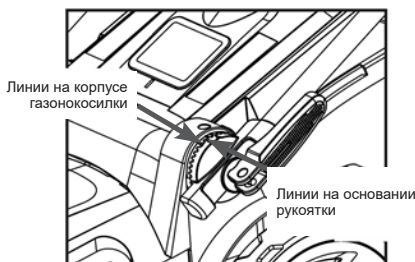
Рис. 3 Установка нижней части рабочей рукоятки
