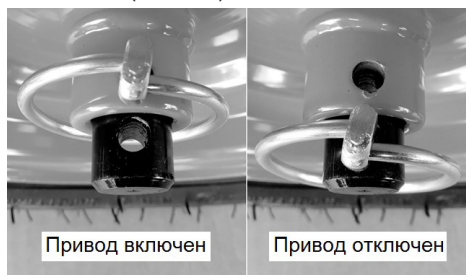
Рис. 32. Перестановка шплинта на левом колесе
