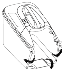
Рис. 7. Крепление нижней части травосборника
