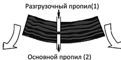
Рис. 26. Распиливание дерева, когда его нижняя часть находится под напряжением
