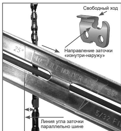
Рис. 37 Определение угла заточки
