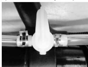
Рис. 8 Установка выпускного шланга на штуцер запорного крана
