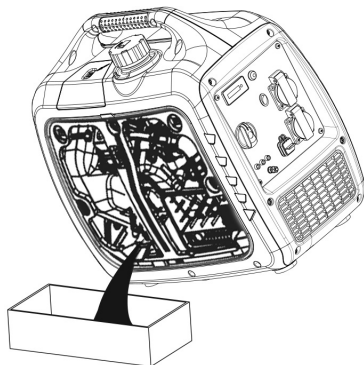
Рис. 13. Замена масла в двигателе
