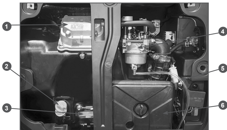
Рис. 3. Основные узлы и органы управления (вид со снятой левой панелью)
