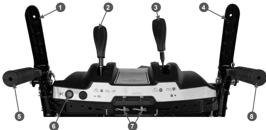
Рис. 2 Панель управления (вид со стороны оператора)
