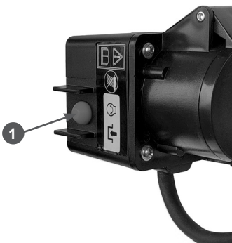
Рис. 35 Кнопка включения электрического стартера 1. Кнопка
