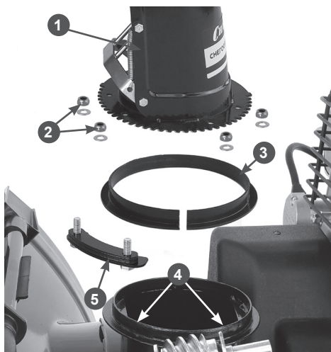
Рис. 18 Установка жёлоба выброса снега
