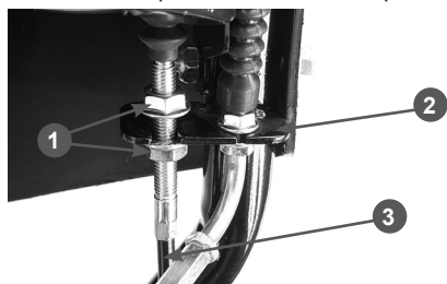
Рис. 10 Крепление оболочки троса включения хода
