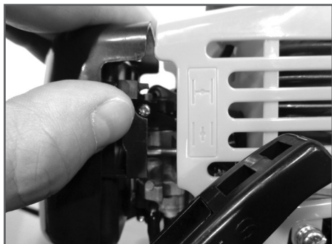
Рис. 4 Рычаг управления воздушной заслонкой в положении «ЗАКРЫТО»
