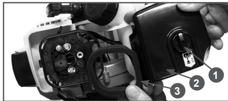
Рис. 9 Обслуживание воздушного фильтра
