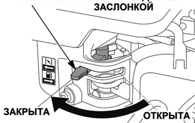
Рис. 9 Воздушная заслонка закрыта
