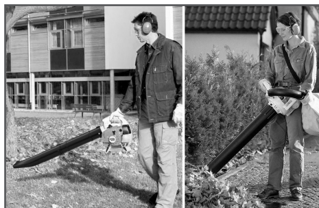
Рис. 9 Положение оператора при работе воздуходувным устройством
