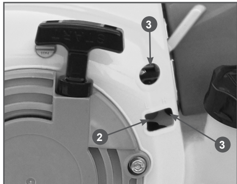
Рис. 13 Винты регулировки карбюратора 1 - винт «Т», 2 – винт «L», 3 - винт «H»
