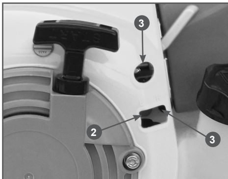
Рис.8 Винты регулировки карбюратора 1 - винт «Т», 2 – винт «L», 3 - винт «H»
