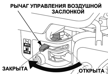
Рис. 9 Воздушная заслонка закрыта
