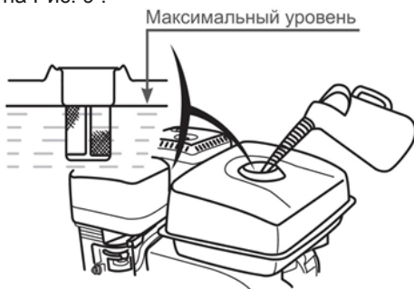
Рис. 9 Максимальный уровень топлива в топливном баке
