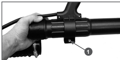
Рис. 4 Установка рукоятки управления
