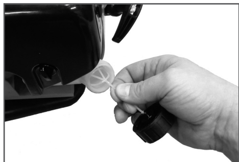
Рис. 14 Снятие крышки топливного бака
