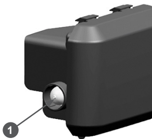
Рис. 13. Расположение ручного топливного насоса
