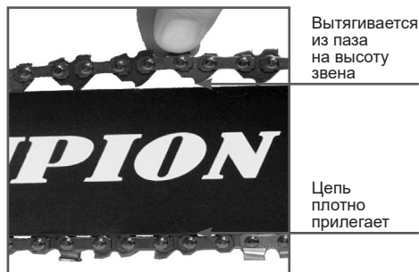
Рис. 5 Регулировка натяжения цепи
