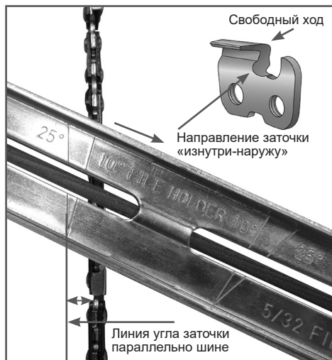
Рис. 16 Определение угла заточки
