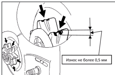
Рис. 14 Проверка износа звездочки
