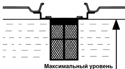
Рис. 11 Максимальный уровень топлива в топливном баке
