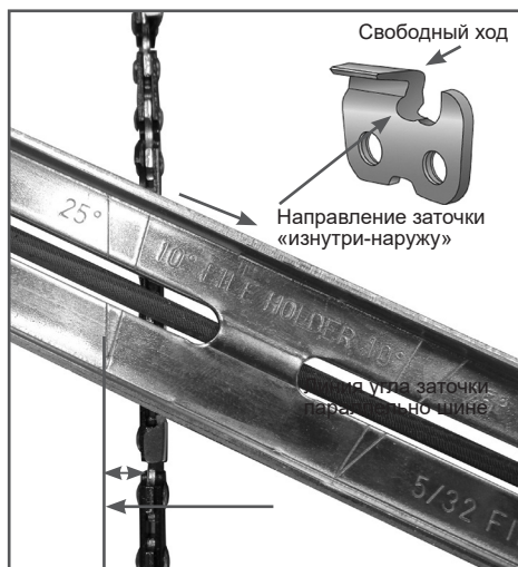
Рис. 22 Расположение линии угла заточки
