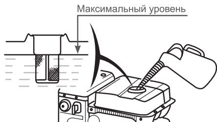
Рис. 31 Максимальный уровень топлива в топливном баке
