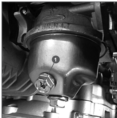
Рис. 22 Слив топлива из карбюратора
