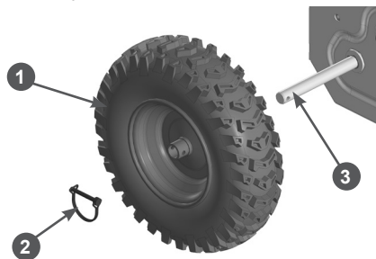
Рис. 7. Установка правого колеса
