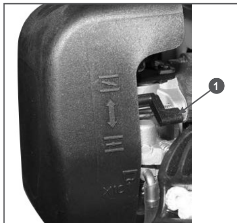
Рис. 6 Расположение рычага управления воздушной заслонкой
