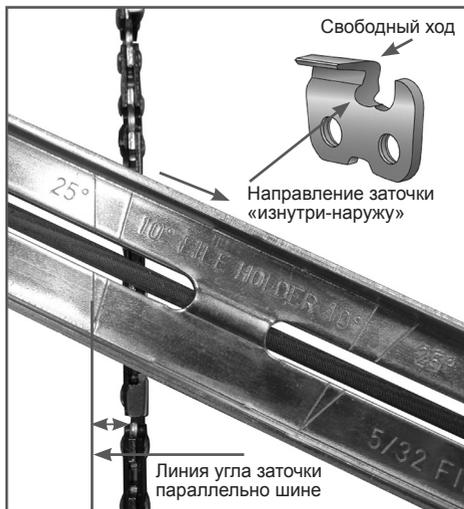
**Рис.18 Определение угла заточки**
