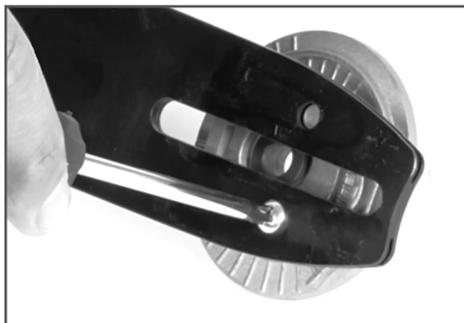
Рис. 13 Переворачивание шины
