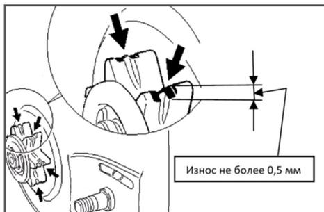
Рис. 16 Проверка износа звездочки
