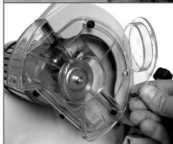
Рис. 3 Снятие крышки защитного кожуха
