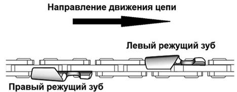
Рис. 12 Определение типа режущего зуба
