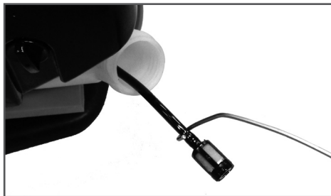
Рис. 15 Извлечение топливного фильтра
