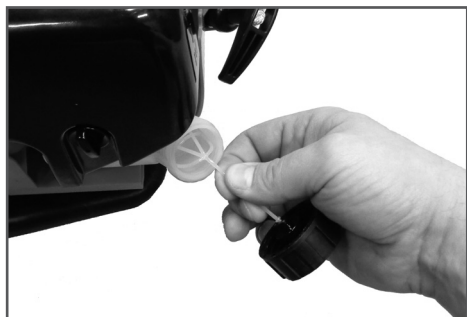
Рис. 14 Снятие крышки топливного бака
