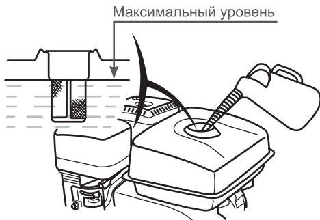
Рис. 18 Максимальный уровень топлива в топливном баке
