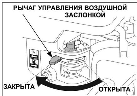
Рис. 7 Рычаг управления воздушной заслонкой
