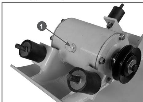
**Рис. 21 Расположение пробки для заправки масла в вибратор**
