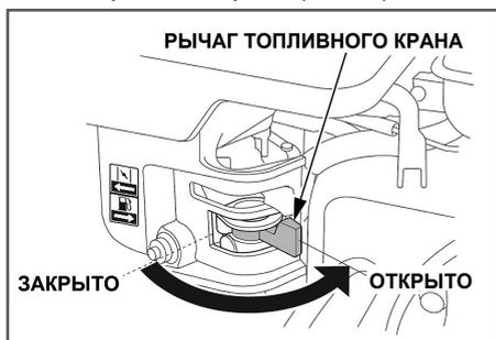
Рис. 8 Рычаг топливного крана
