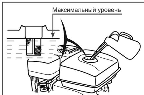
**Рис. 6 Максимальный уровень топлива в топливном баке**
