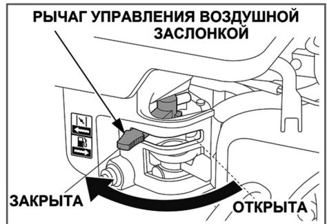
Рис. 11 Воздушная заслонка закрыта
