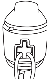
Рис. 7. Крепление кабеля удлинителя
