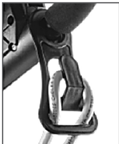
Рис. 10 Фиксация кабеля удлинителя на рабочей рукоятке
