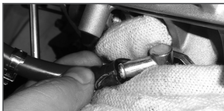
Рис. 10 Удаление воздуха из топливного шланга
