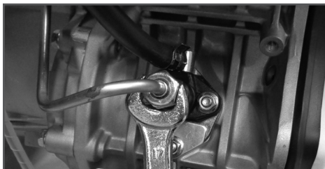
Рис. 12 Удаление воздуха из топливного насоса
