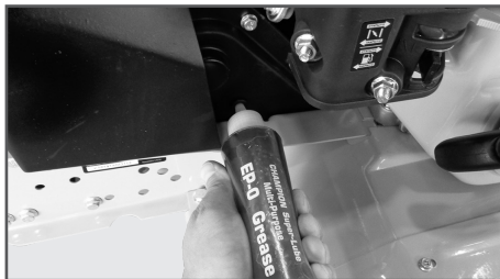
Рис. 25 Добавление смазки в редуктор
