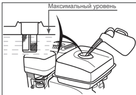
Рис. 12 Максимальный уровень топлива в топливном баке
