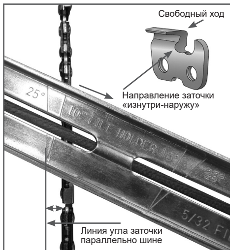
Рис. 23 Расположение линии угла заточки
